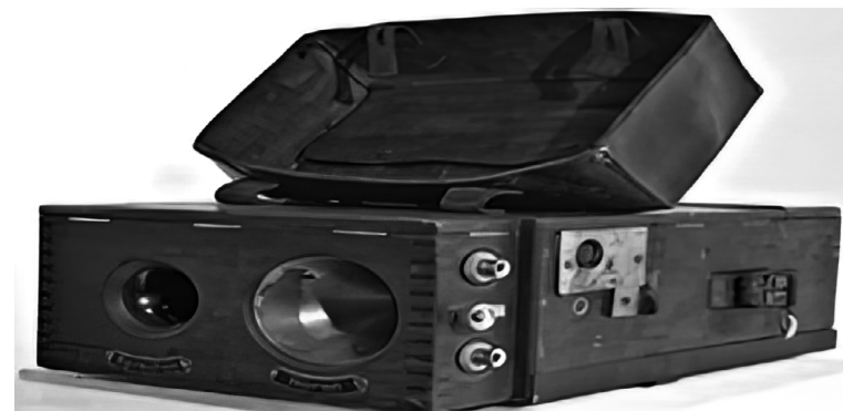
Телефонен апарат „Сименс - Халске“ с фонично повикване и високоговорител на слушалка.
